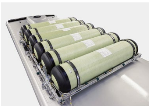
Die Behälter zur Speicherung der gasförmigen Kraftstoffe sind meist auf dem Dach angebracht
