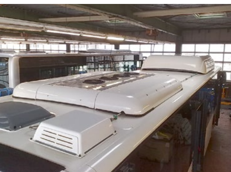
Die Behälter zur Speicherung der gasförmigen Kraftstoffe sind meist auf dem Dach angebracht
