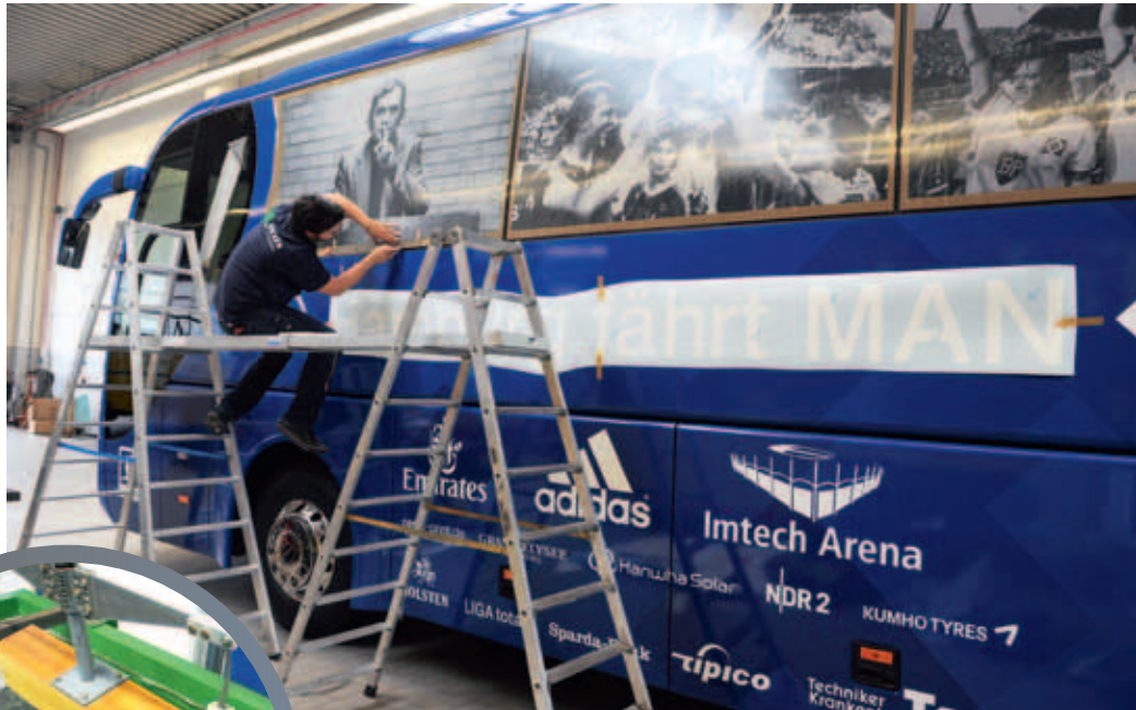
Auf Scheiben geklebte Folien bedürfen einer Bauartgenehmigung, die erst nach Tests wie dem Phantomfallversuch (I.) vergeben wird
