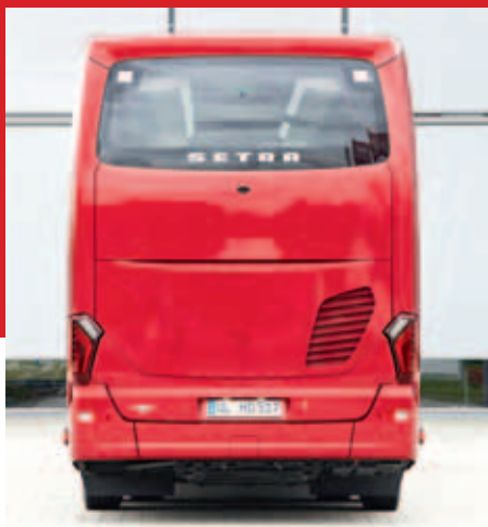
Bei Setra erkennt man die ComfortClass 500 mit Euro 6 am markanten einseitigen Lüftungsgitter
