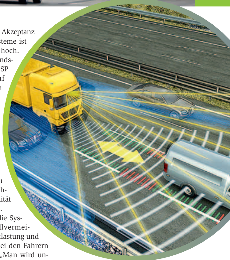
Künftig überwachen Sensoren alles, was um das Fahrzeug herum passiert – und melden Gefahren
